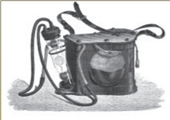
1862 Dumas et Benoît's Electrical miner lamp
